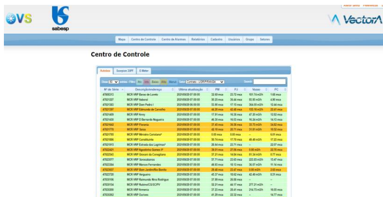
Figura 3: Painel inicial Sistema de Controle e monitoramento de VRP VECTORA - Fonte: unidade de Negócio Centro
